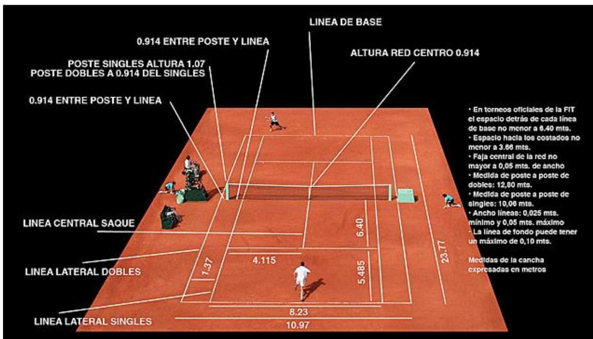
Figura 1 Dimensiones de la cancha de tenis. Fuente: <http://www.tenisfans.com.ar/fotos/medidascanchafoto.jpg> más información en el siguiente enlace: [http://www.oficad.com/medidas\\_y\\_dimesnsiones/pista\\_de\\_tenis.htm](http://www.oficad.com/medidas_y_dimesnsiones/pista_de_tenis.htm)
